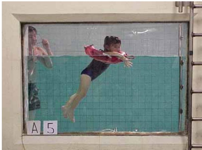
写真3 浮力試験水槽における幼児用救命胴衣の浮遊性能試験
