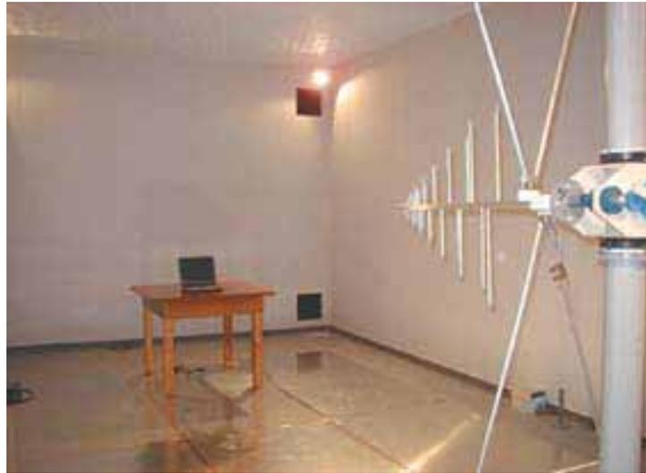
写真6 EMC試験電波暗室とアンテナ類
