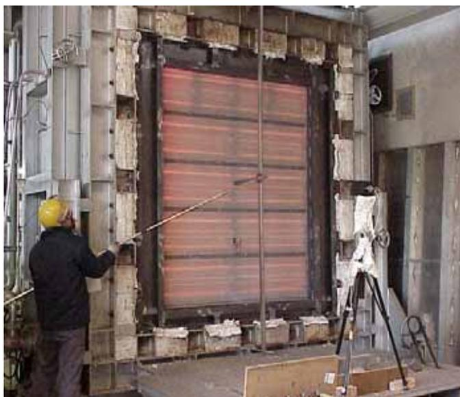
写真7 シャッタの標準火災試験
