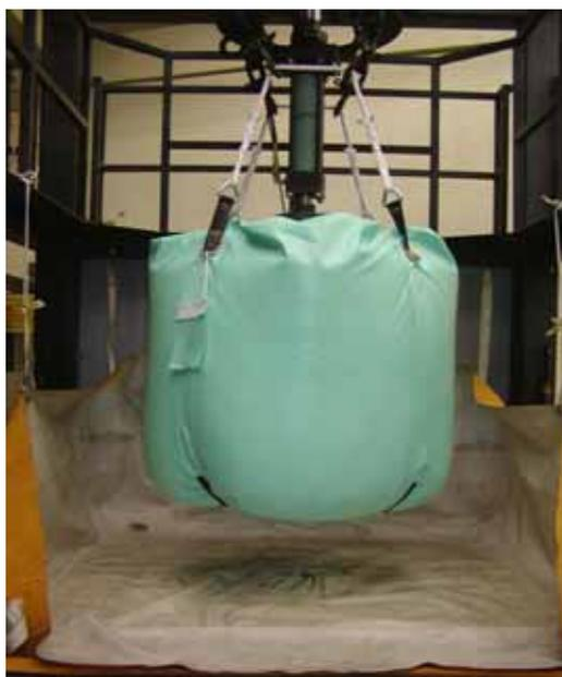
写真5 フレキシブルコンテナの吊り下げ試験
