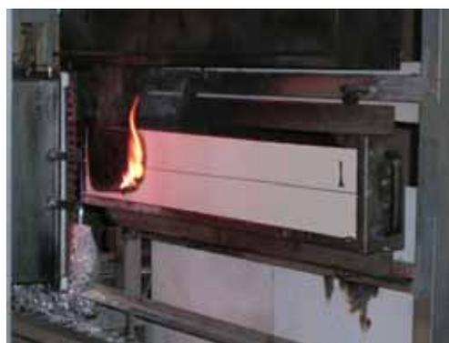
表面燃焼性試験 (part5) 試験の様子
