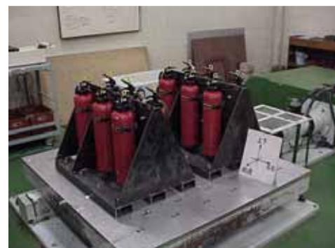
大型電気油圧式振動試験機 (EVH-20-35-10)
