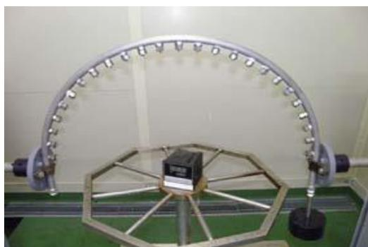
IPX3、IPX4 振動管による試験
