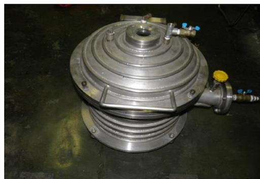
IPX8 水圧試験機 (最大使用水圧 : 0.3MPa)
